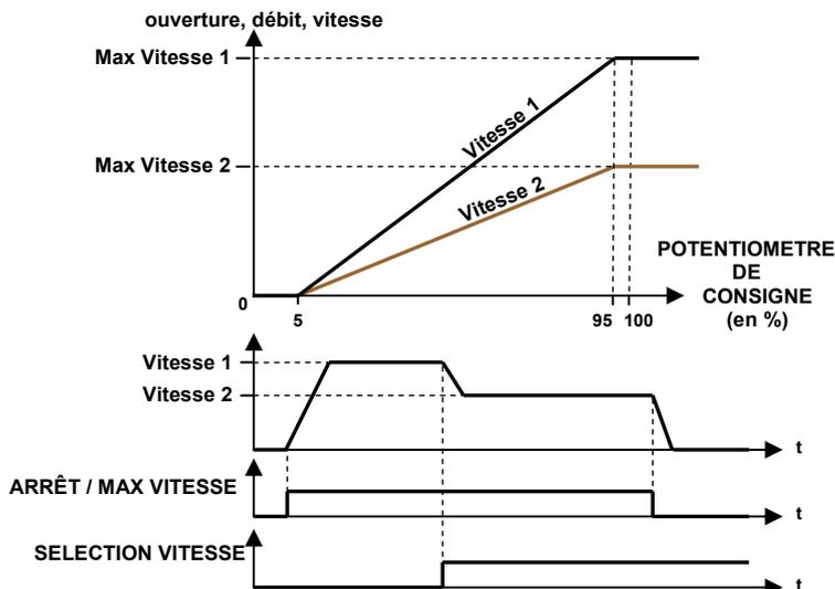
**Réglage de la vitesse 1 (Pot MIN) :** Ne pas shunter l'entrée « SELECTION VITESSE » avec +ALIM, positionner le potentiomètre de consigne en butée maxi (butée lorsque que l'on tourne le potentiomètre dans le sens horaire) ou l'interrupteur « ARRÊT / MAX VITESSE » sur ON. Régler la vitesse 1 avec le potentiomètre MIN de la face arrière.
