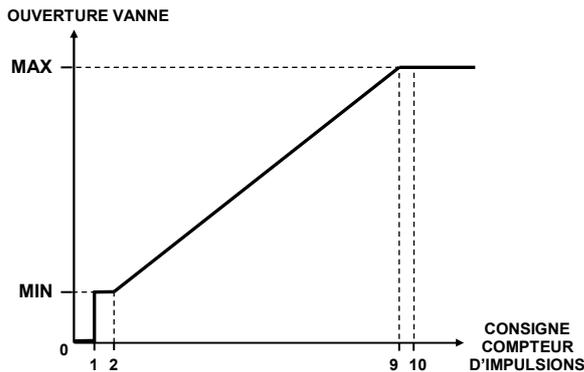
10 impulsions sur l'entrée PLUS sont nécessaires pour ouvrir la vanne du minimum au maximum. 10 impulsions sur l'entrée MOINS sont nécessaires pour fermer la vanne du maximum au minimum.
