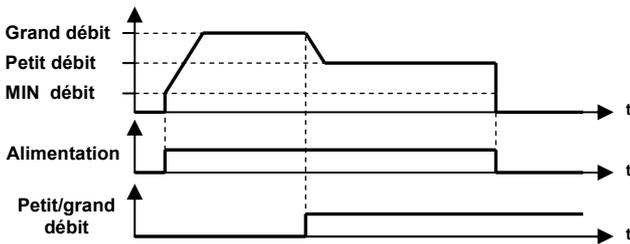
**Réglage de l'ouverture MIN :** Positionner le potentiomètre de consigne à 0 (butée lorsque que l'on tourne le potentiomètre dans le sens anti-horaire). Puis tourner le légèrement dans l'autre sens jusqu'à ce que la led clignote. Régler l'ouverture minimale avec le potentiomètre MIN de la face arrière.
