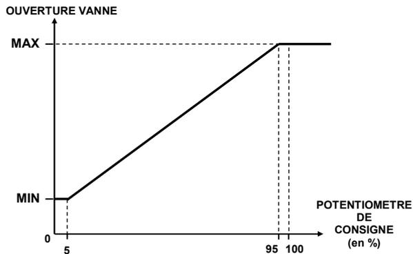
**Réglage de l'ouverture MIN :** Positionner le potentiomètre de consigne à 0 (butée lorsque que l'on tourne le potentiomètre dans le sens anti-horaire). Régler l'ouverture minimale avec le potentiomètre MIN de la face arrière.
