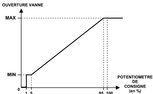
**Réglage de l'ouverture MIN :** Positionner le potentiomètre de face avant à 0 (butée lorsque que l'on tourne le potentiomètre dans le sens anti-horaire). Puis tourner le légèrement dans l'autre sens jusqu'à ce que la led clignote. Régler l'ouverture minimale avec le potentiomètre MIN de la face arrière.
